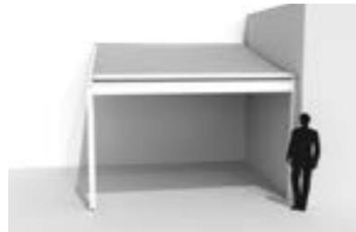
**Anbausituation 4** - Gegen dahinterliegende und rechte Konstruktion
