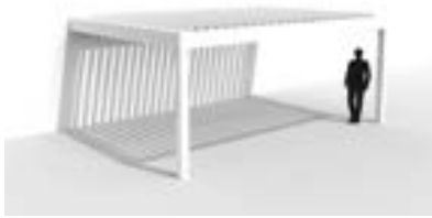
Fassadenmontage: der Rahmen wird mit einer oder 2 Seiten gegen eine dahinterliegende Trägerkonstruktion oder Struktur angebracht. Vertikale Pfosten stützen den anderen Teil. Die Lamellen können parallel oder senkrecht zur rückseitigen Struktur angeordnet werden.
