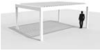
Freistehend: der Rahmen der Camargue Line wird von 4 vertikalen Pfosten gestützt.
